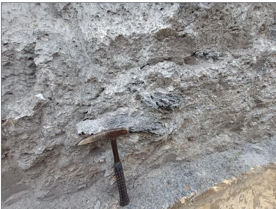
Figura 4-2 – Imagens de solo residual (poço para extração de amostra em solo residual silto-arenoso, de coloração acinzentada).
